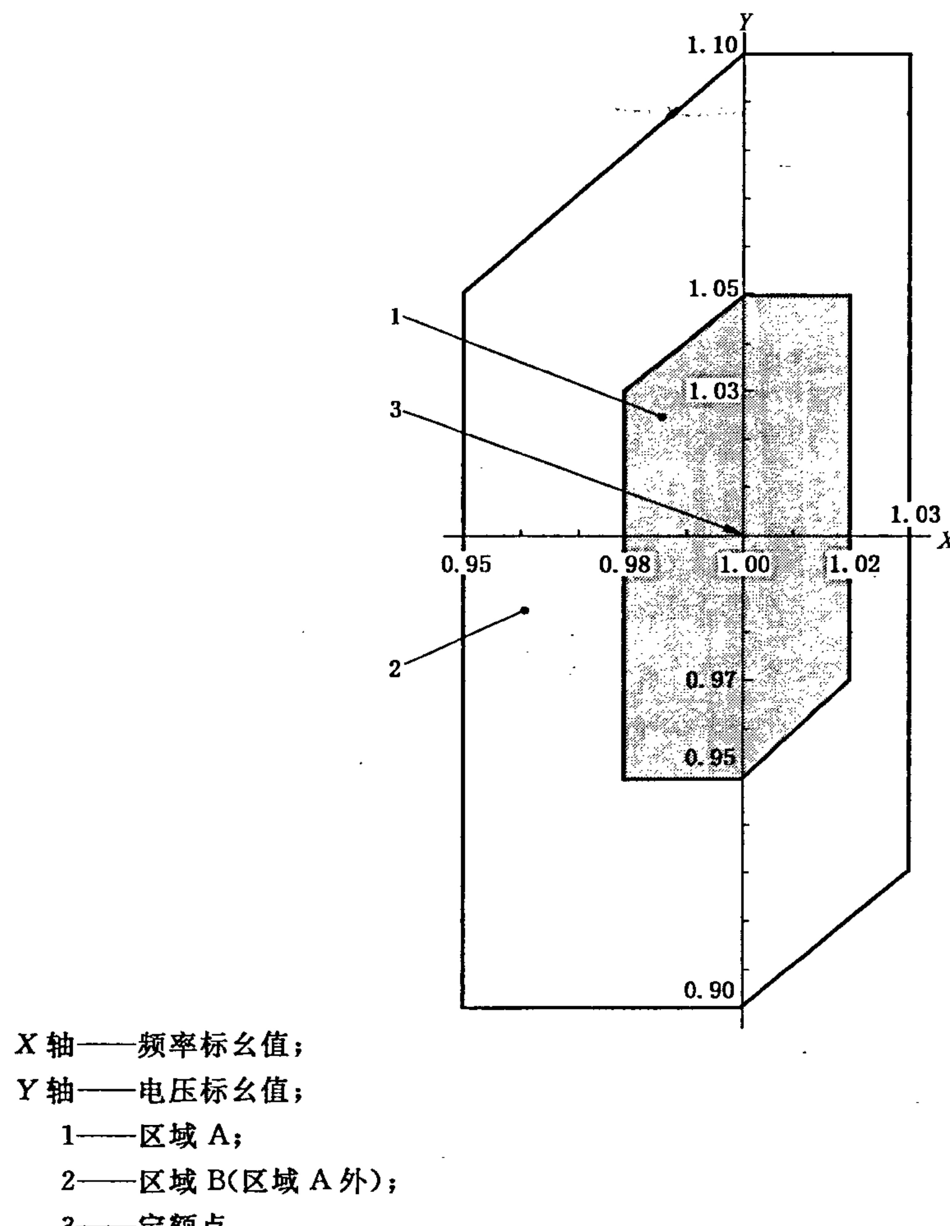
图 12 电动机的电压和频率的限值
