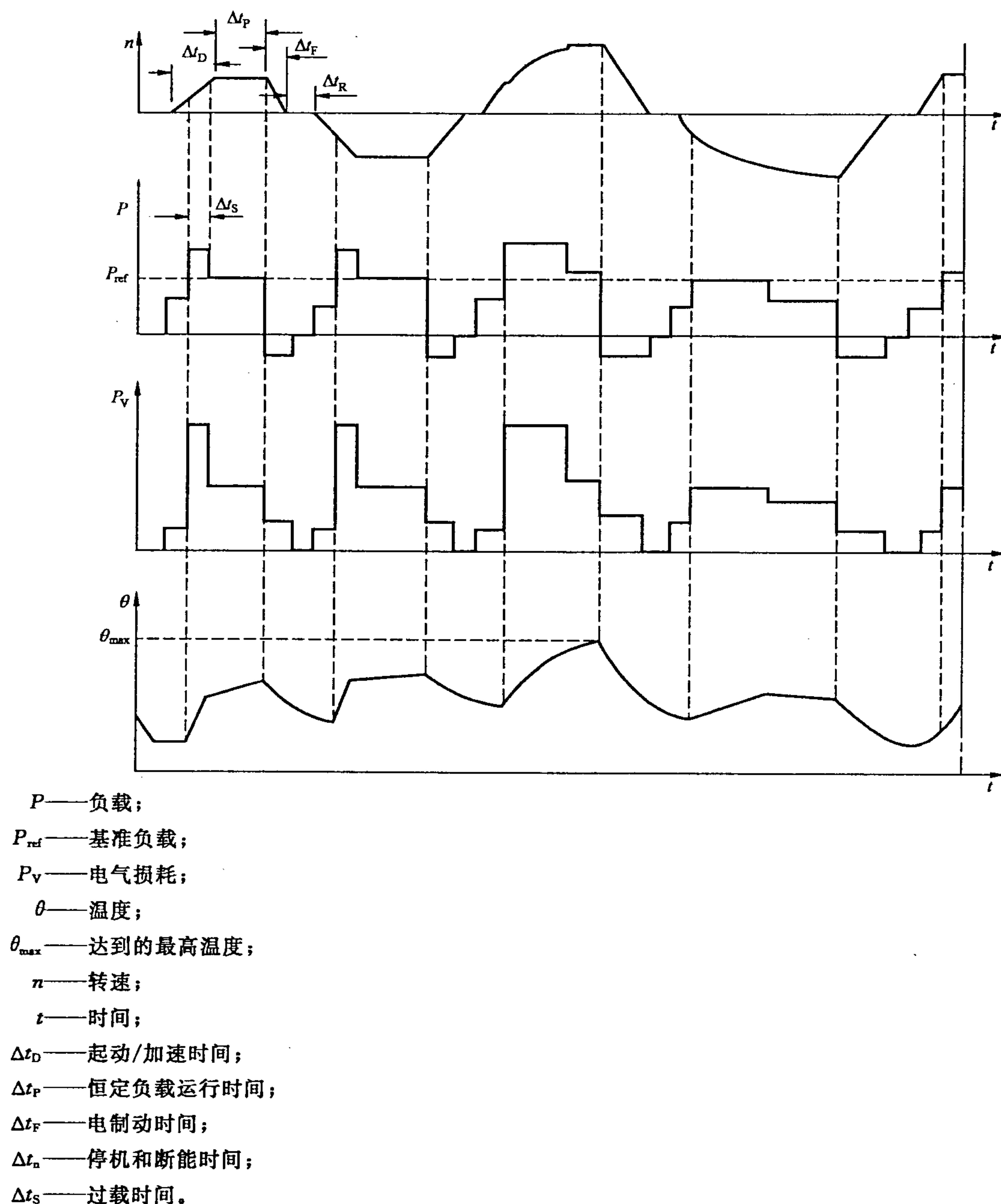
图 9 负载和转速作非周期变化的工作制 S9 工作制
